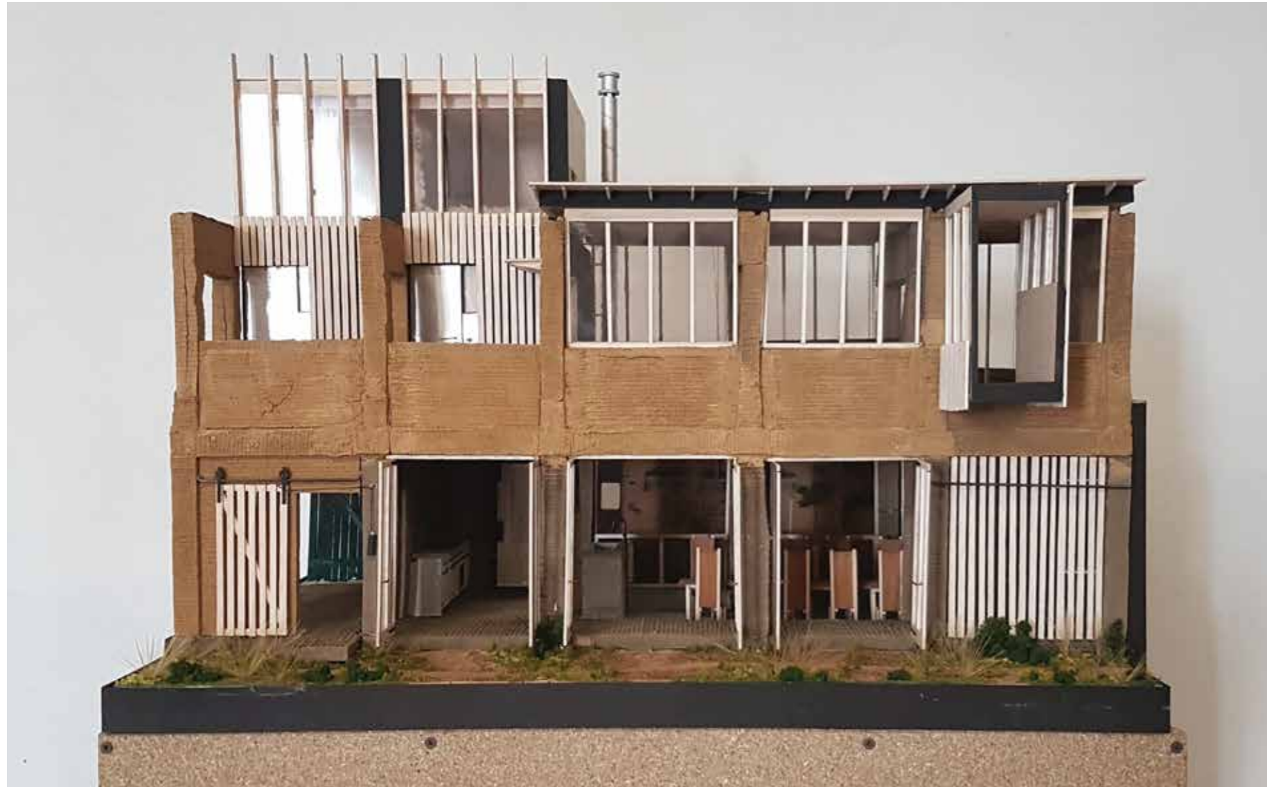
Fragment van de woning achter de muur, uitgewerkt in schaal 1:20. Onder de gemeenschappelijke eet- en woonkamer, boven twee kamers.
