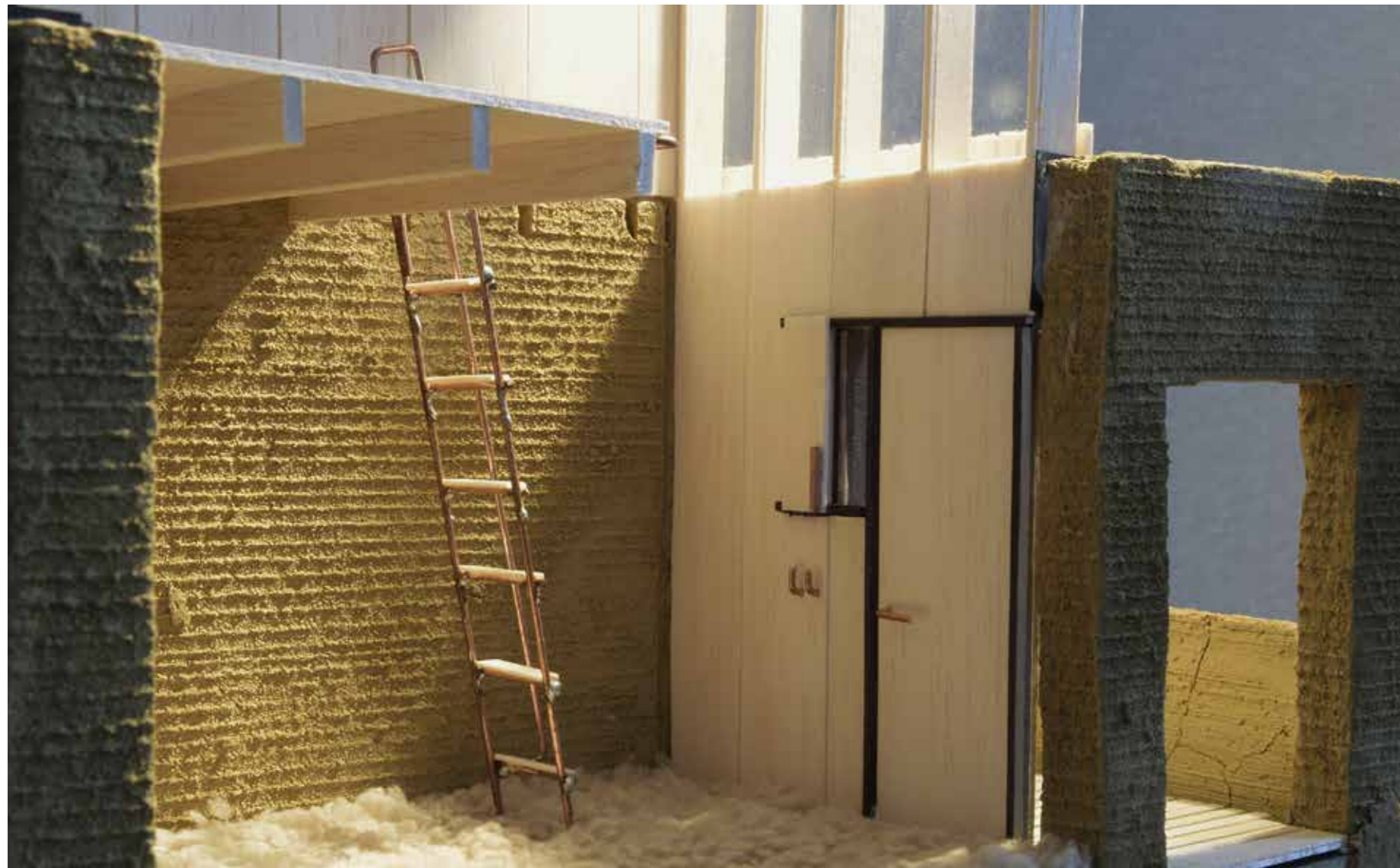
De basis van het ontwerp bestaat uit een gemetseld frame, waarbij de specie uitsteekt t.o.v. de steen. Dit geeft een grove, enigszins willekeurige structuur, waardoor het nieuwe gebouw niet opzettelijk 'verouderd' hoeft te worden. De donkere, wat zware materialen scheppen een atmosfeer van rust, terwijl de houten invulling van het frame juist weer wat lichtheid biedt.
