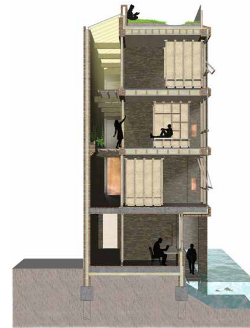
Dwarsdoorsnede. Boven de woningen met het verrijdbare slaapmeubel, onder de studieruimtes met uitzicht op het water. De drijvende vlonder biedt toegang tot het gebouw, waardoor de beweging van het water ervaren wordt en de pas enigszins vertraagt.
